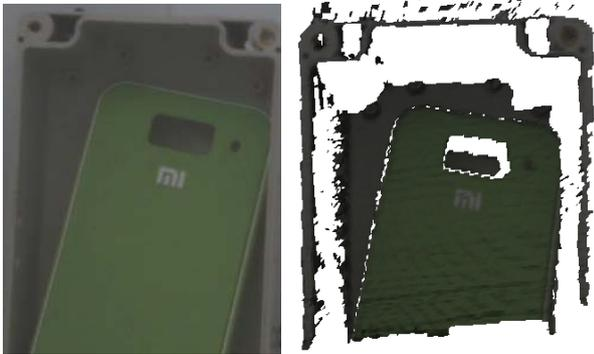
图 10 实物和扫描的纹理映射效果图
